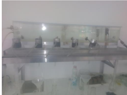
Imagen3: Máquina para determinar la conductividad eléctrica. Fuente: Cristian David Barrera Londoño
